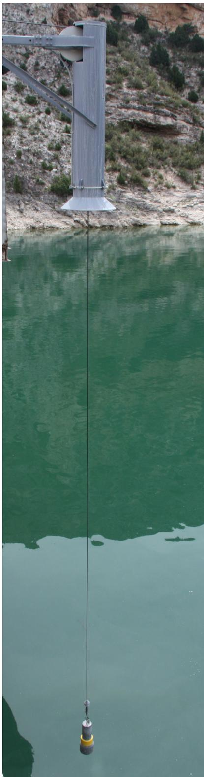
El equipo **AQUADAM** está compuesto principalmente por un sistema automático de posicionamiento, una sonda multiparámetro, un automático de gestión y un sistema de comunicaciones con el centro de control donde se recibe la información, para su posterior estudio.
