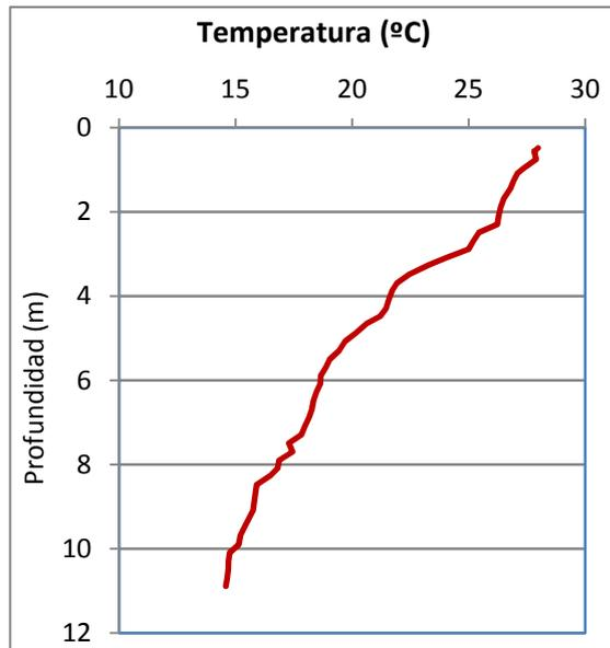
La temperatura del agua oscila entre los 14,58 °C – en el fondo- y los 27,98 °C - máximo registrado en superficie-. En el momento del muestreo (Junio 2015) se observa la termoclina entre los 2 y 6 metros de profundidad.
