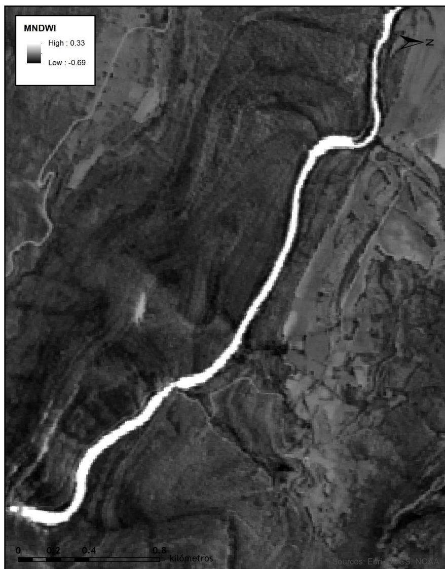
Figura 3. Índice NDWI aplicado a la imagen de satélite para identificar la lámina de agua
