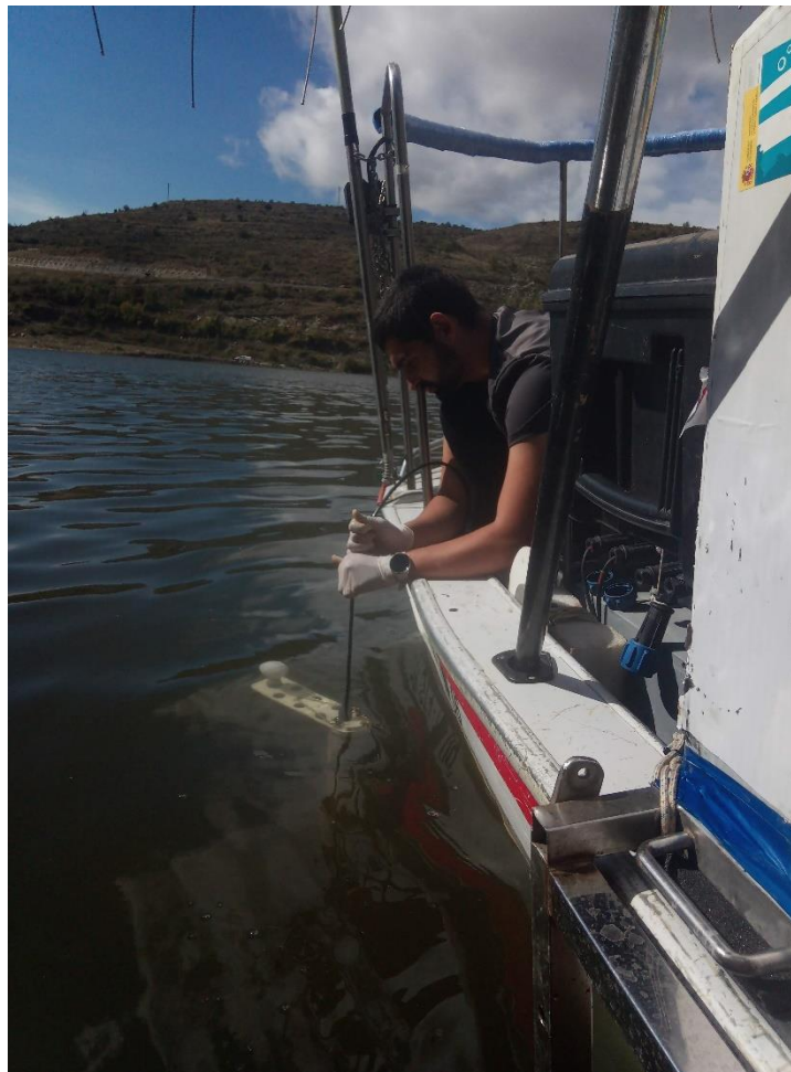
Figura 7. Técnico realizando el perfil vertical mediante sonda multiparamétrica
