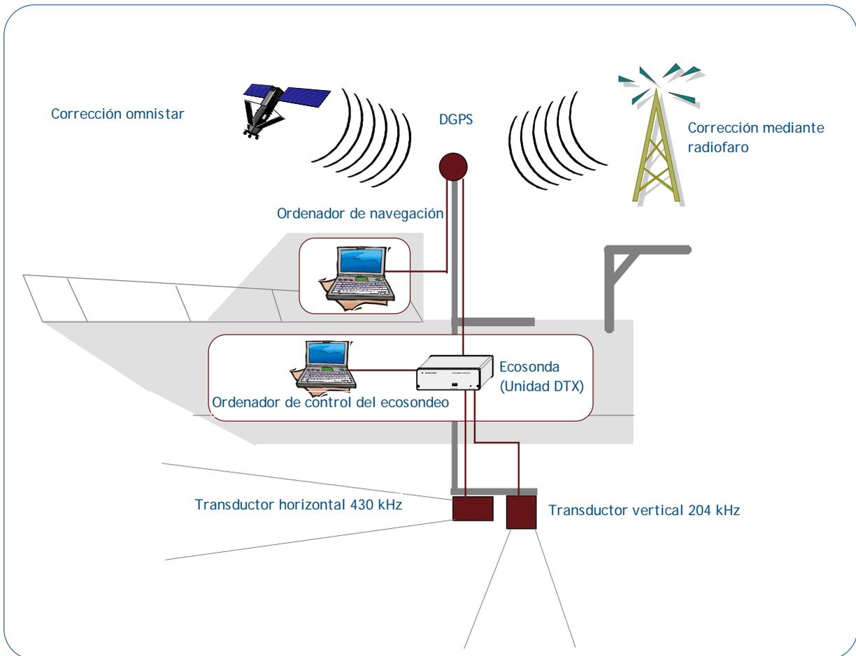
Figura 5. Esquema de la disposición de elementos y comunicaciones en el sondeo acústico
