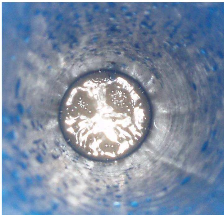
Figura 3.32. Burbujeo en el piezómetro Pz6.
