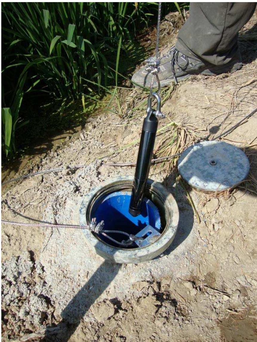
Figura 3.28. Instalación de diver CTD en el piezómetro Pz10.
