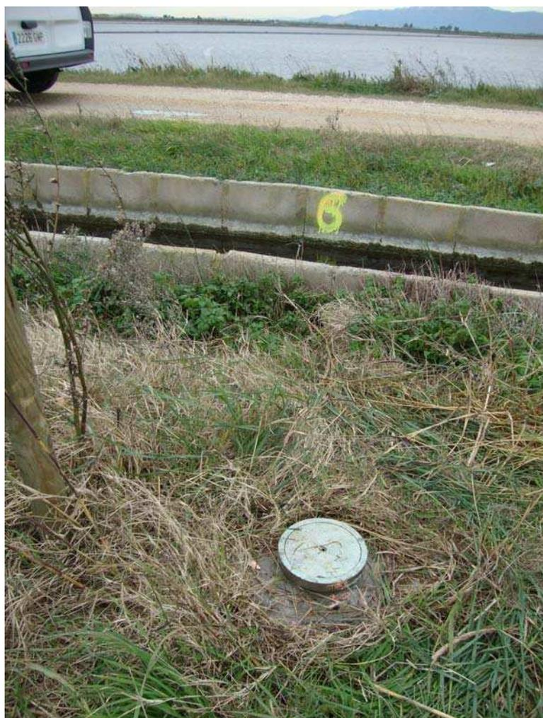
Figura 4.26. Detalle del piezómetro Pz6.
