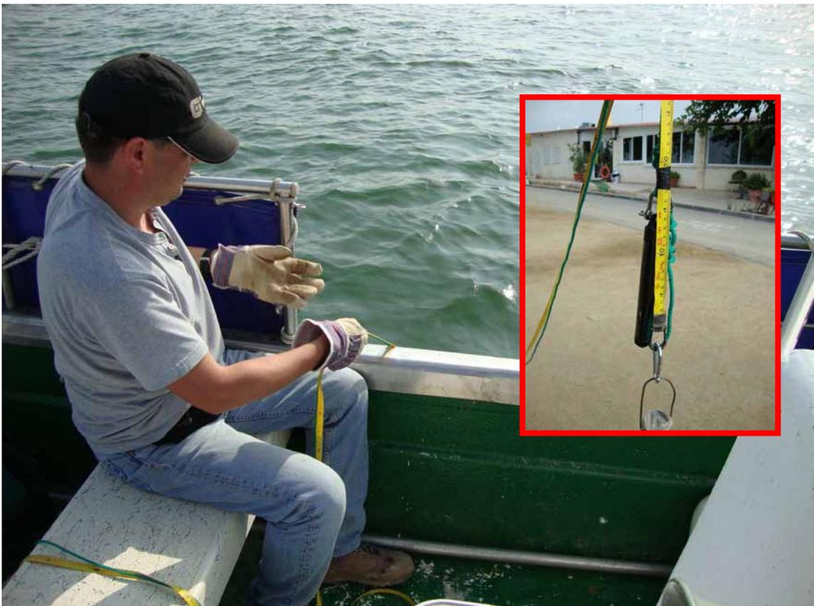
**Figura 4.1. Realización de los perfiles de salinidad en el río y detalle del dispositivo.**
