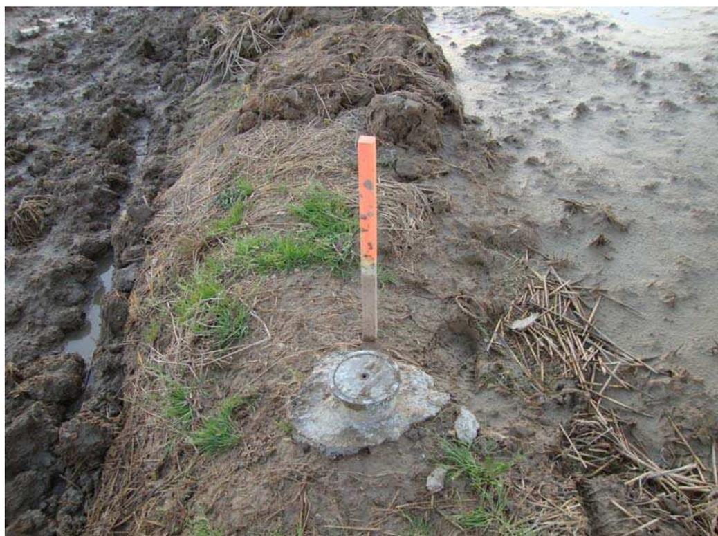
Figura 4.41 Detalle del piezómetro Pz10.
