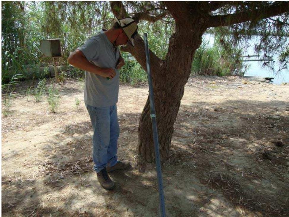
Figura 3.29. Entubación utilizada para la instalación del diver CTD en PR3.
