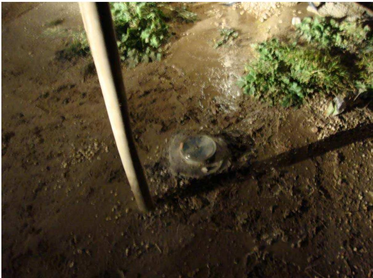
Figura 4.9. Detalle del piezómetro Pz2.
