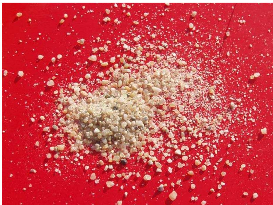
Figura 3.27. Grava silícea de 2.5 mm utilizada como prefiltro.
