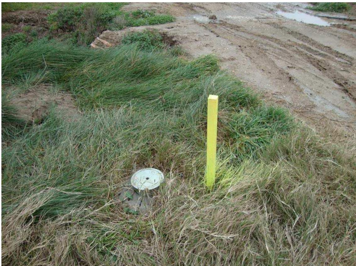
Figura 4.30. Detalle del piezómetro Pz7.
