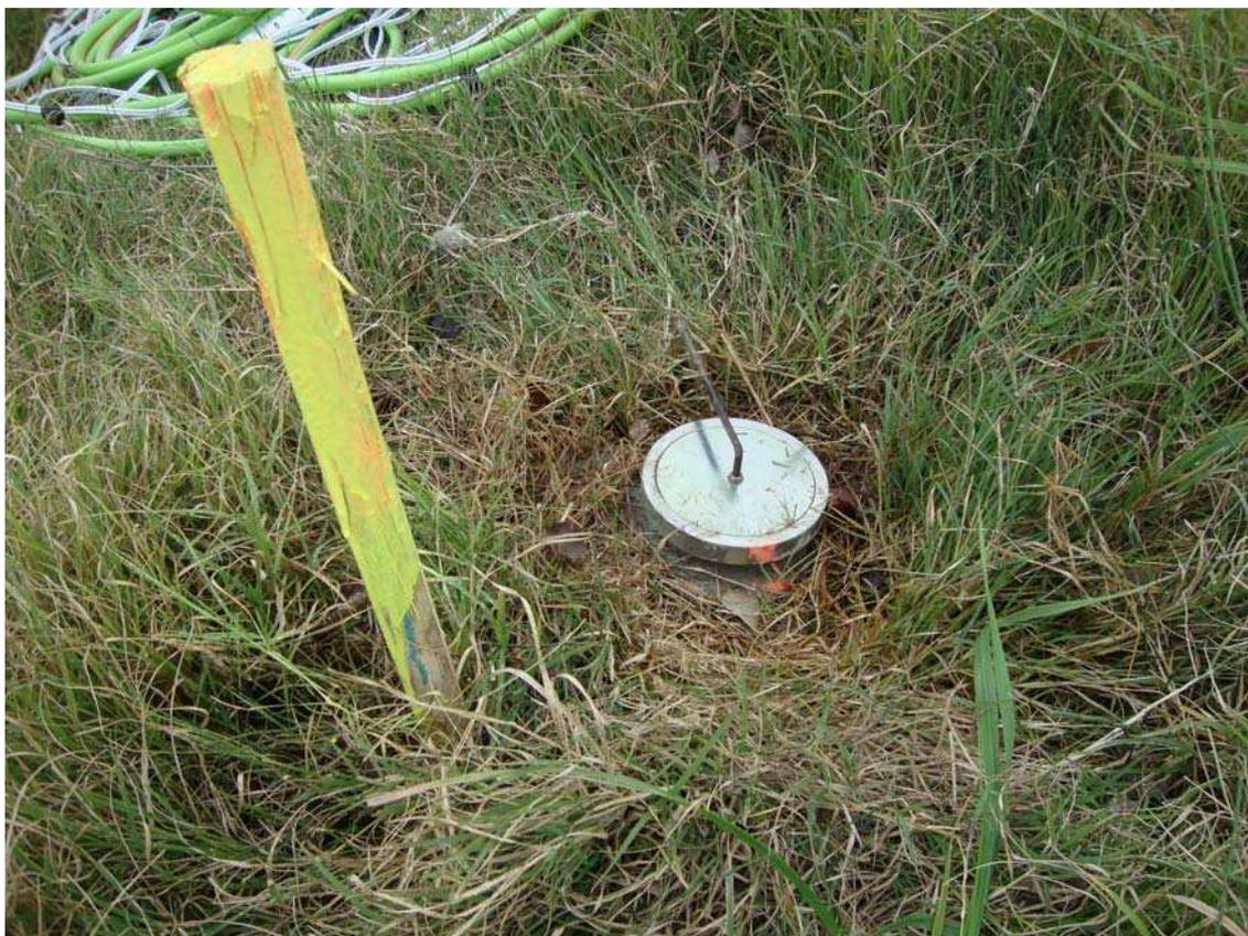
Figura 4.22. Detalle piezómetro Pz5.
