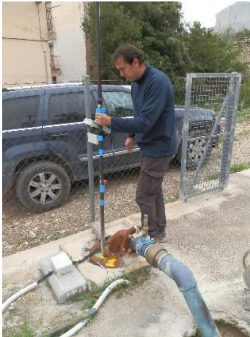
Foto 1. Nivelación pozo 1 Aldover
