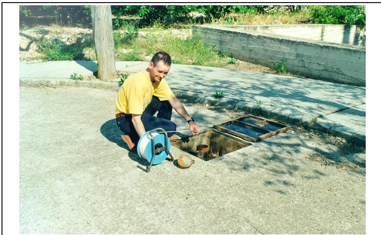
FOTO RED DE CALIDAD. PUNTO TOMA DE NIVEL EN PIEZÓMETRO PRÓXIMO. EDUARDO GARCÍA (22/05/2000)
