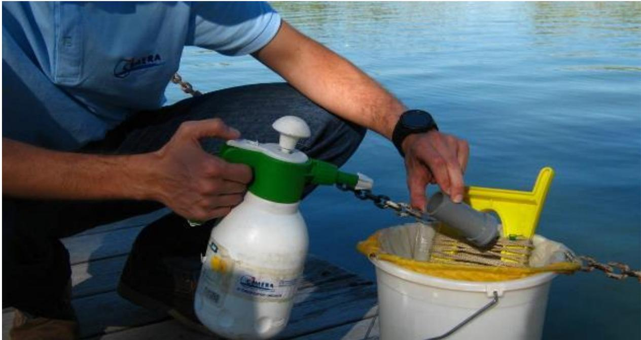
**Figura 8** Desinfección del equipo de muestreo mediante atomización
