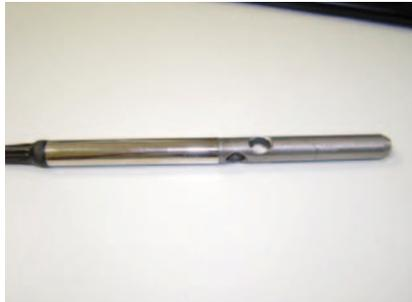
Prototipo en hierro protector sensor sonda.
