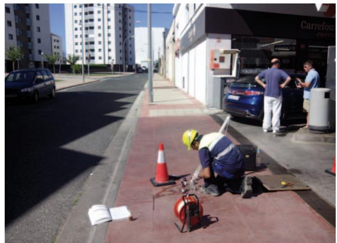
Toma de muestras en un punto de control de la RCON en una gasolinera.
