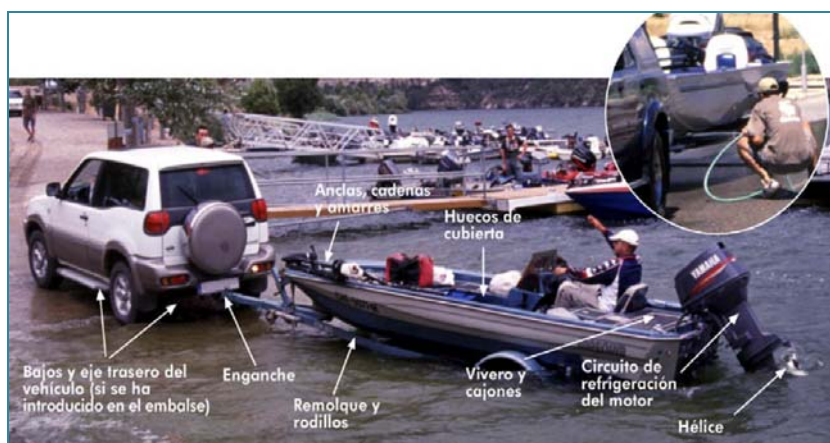
Limpieza del elementos exteriores de la embarcación, remolque y vehículo
