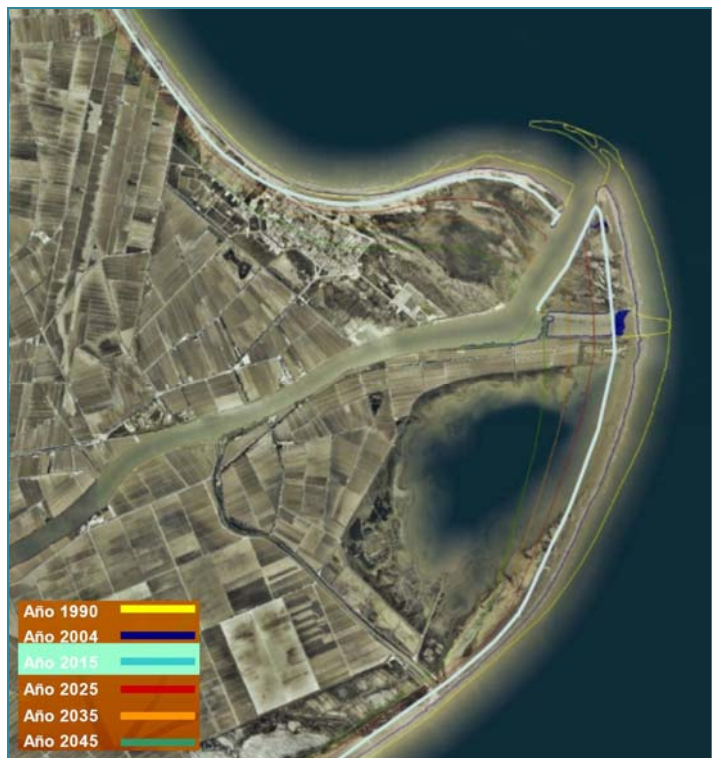
Retroceso de línea de costa esperable entre 1990-2045 en la desembocadura del río Ebro (Fuente: «Plan Director para la Gestión Sostenible de la Costa. El Delta del Ebro», MARM)
