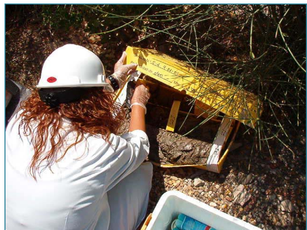
Detección de radionucleidos (Fuente: ACUAMED)
