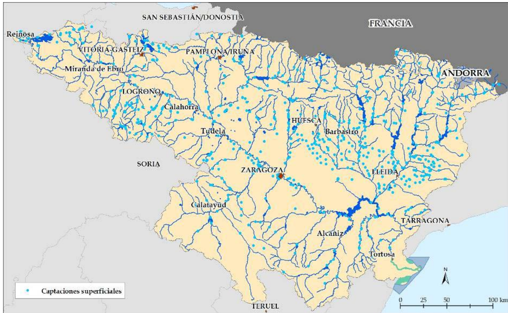
Figura 56 - Captaciones de agua superficiales para abastecimiento en la Cuenca del Ebro
