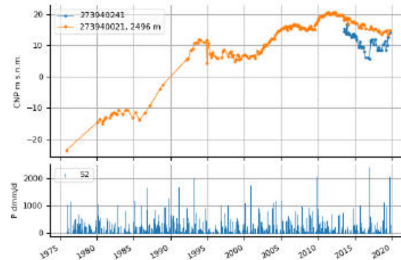
Evolución de la cota piezométrica en el sondeo 273940241 MASub 070.052. Acuífero Campo de Cartagena - Plioceno
