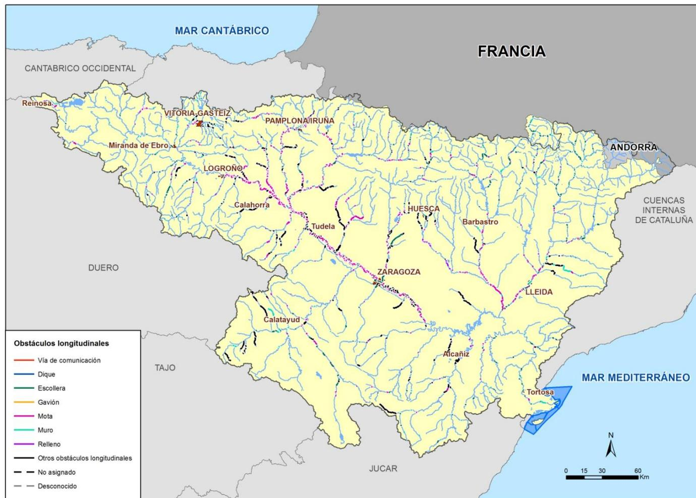
Figura 05.2: Nuevo inventario de obstáculos longitudinales elaborado por el MITECO y que actualmente está en proceso de validación. La información de detalle se puede consultar en la capa Inventario\obstáculos del visor SITEBRO (<http://iber.chebro.es/SitEbro/sitebro.aspx>).
