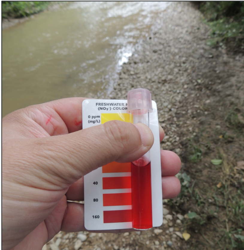
Concentración de nitratos en el río Robo en Puente la Reina (29/6/2017)
