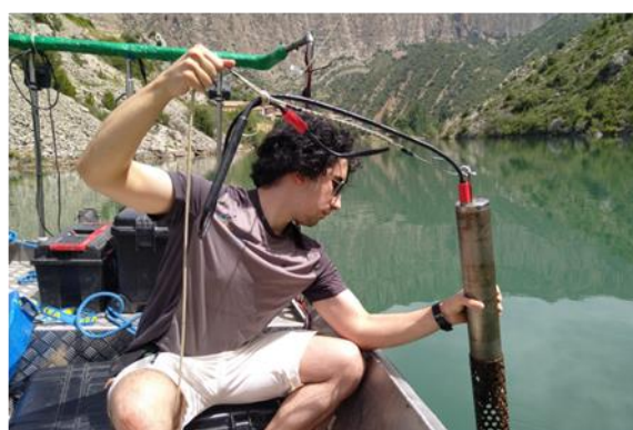
Toma de parámetros con sonda Sea&Sun Tech.
