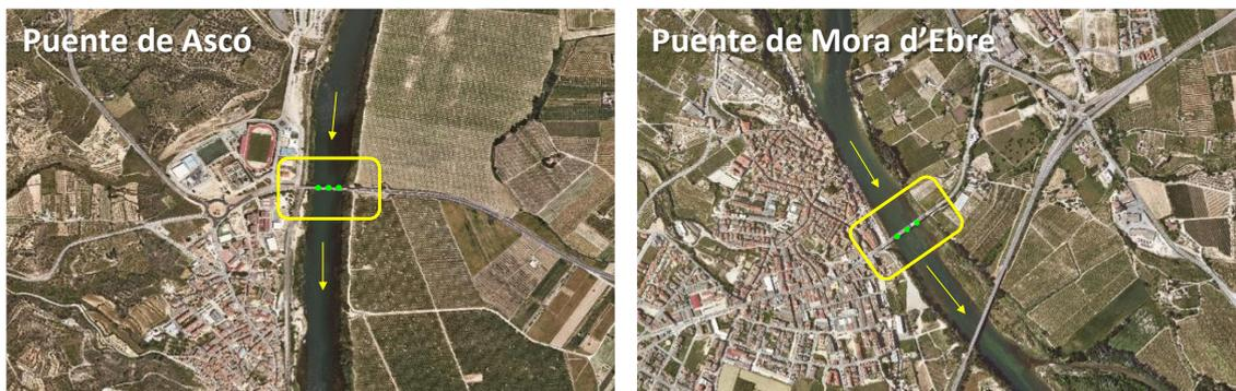
Figura 2. Secciones de control y puntos de muestreo dispuestos transversalmente a lo largo de los puentes de Ascó y Mora d'Ebre. Fuente cartográfica: *Institut Cartogràfic i Geològic de Catalunya*, 2023; escala en origen 1:25.000.
