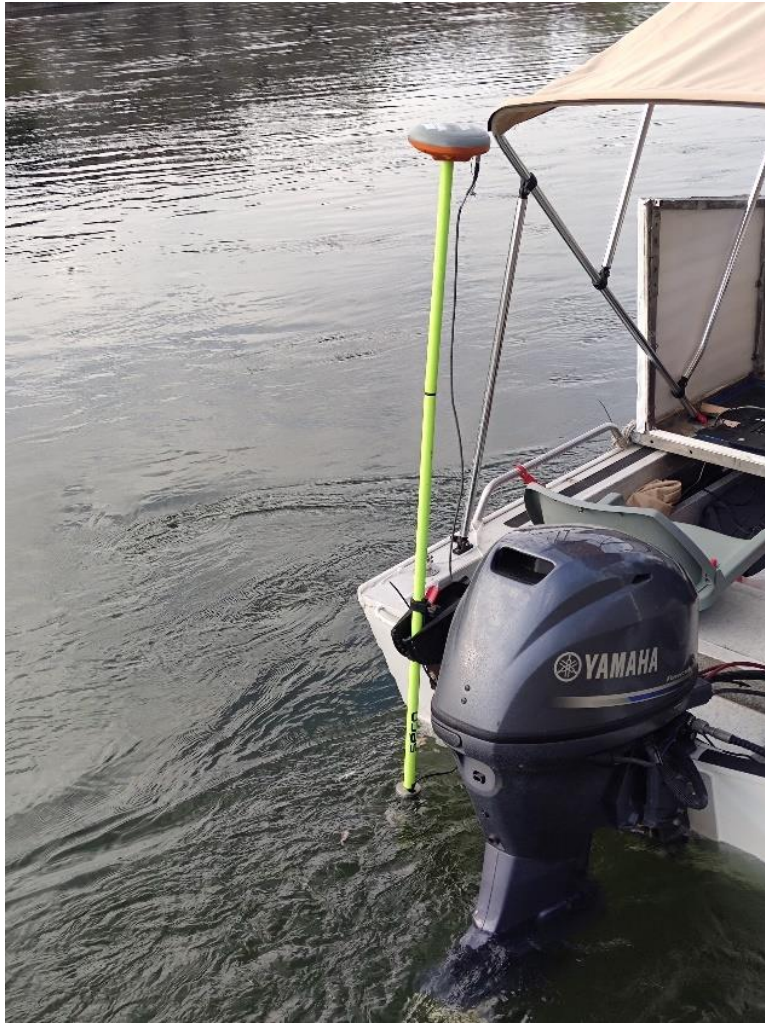
Figura 5. Ecosonda monohazy sistema GPS una vez montada en la popa de la embarcación
