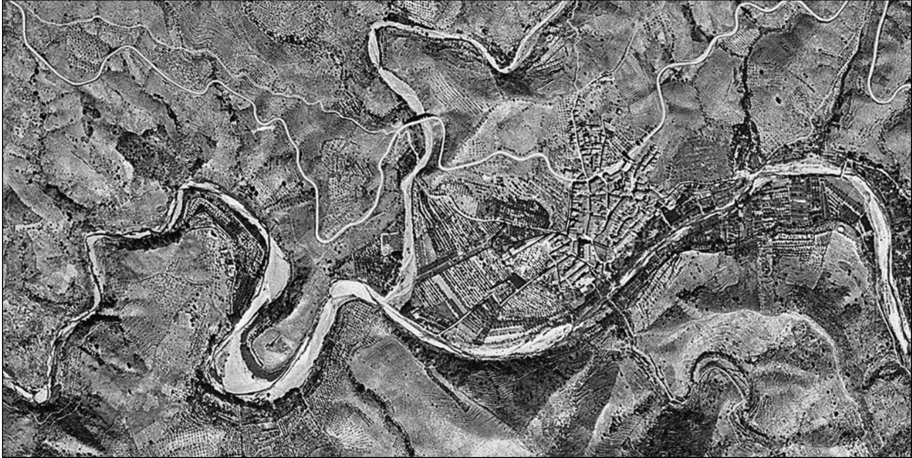
Imagen 1. Ortofotografía aérea del vuelo americano de 1956 en la zona del río Siurana a su paso por Poboleda. Destaca un lecho fluvial amplio y muy dinámico, con barras, terrazas y un canal de aguas bajas serpenteante en su interior, todo ello resultado de la inexistencia de regulación hidrológica y de unos usos del suelo (claro predominio de los cultivos sobre las cubiertas forestales) que favorecían una potente acción morfodinámica.
