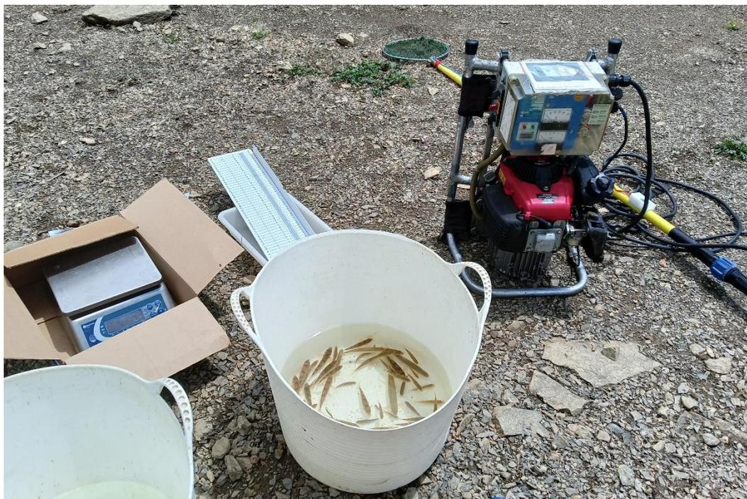
**Figura 8.** Equipo de electropesca de orilla en el Embalse de Escarra
