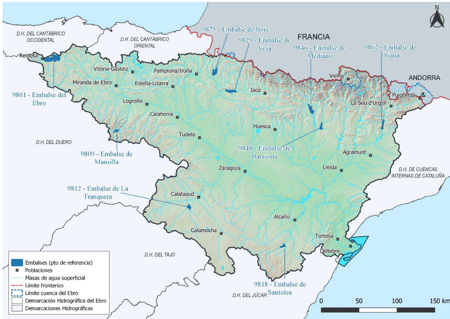
Figura 8. Localización de los puntos de referencia (embalses) que pueden considerarse próximos al régimen natural al estar en cabeceras y no afectados significativamente por usos humanos
