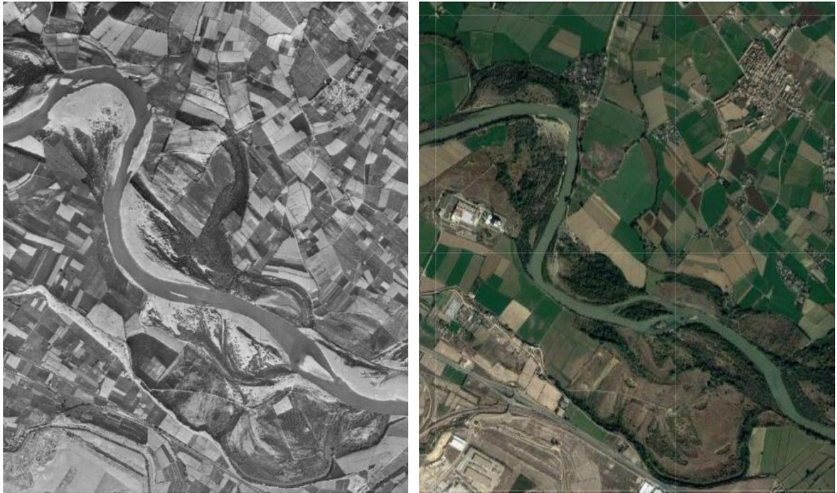
**Figura 4: Tramo del Río Ebro a la altura de Pastriz en el año 1956 (izquierda) y en la actualidad (derecha). Se aprecia la casi total desaparición de las barras de gravas, la reducción de la anchura del cauce de aguas bajas y el mayor desarrollo de la vegetación de ribera, así como la ocupación de antiguos sotos por campos de cultivo.**
